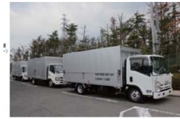
低圧電源車(500kVA, 4台)
