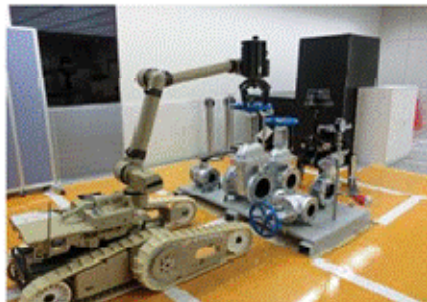
バルブの開閉操作
