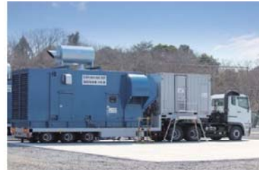
高圧電源車(1725kVA, 5台)
