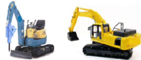
小型・大型無線重機 (屋外のがれき等の除去)
