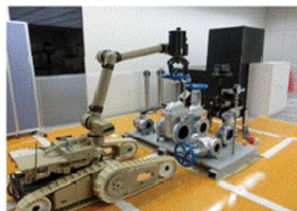
バルブの開閉操作
