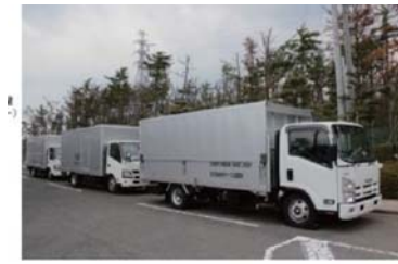
低圧電源車(500kVA, 4台)
