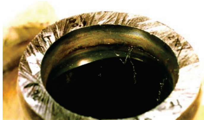
管台側軸方向き裂(き裂は溶接ビード内に達している)
