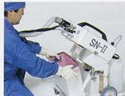
扱い易さを随所に配慮 タンク部はメンテナンス性と移動時を配慮し、分割できる構造としました。また、回収タンクにセンサーを装着しているため、汚水の漏れがない安心設計です。
