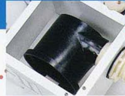
サイクロンセパレーター吸引 吸引された汚水と搬送空気はサイクロンセパレーターで分離され、汚水は回収タンクへ、搬送空気はHEPAフィルターで浄化し排気します。
