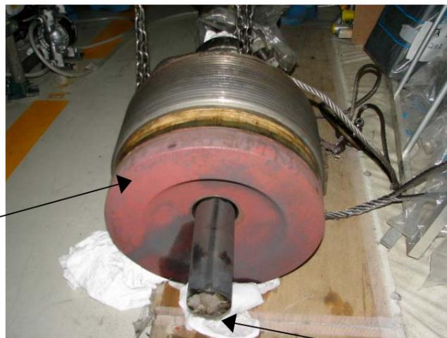
弁棒の破断部
