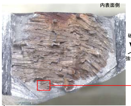
No. 3割れの破面観察結果
