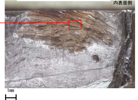
No. 4割れの破面観察結果
