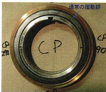
回転リング側摺動面の状況 (材質:シリコンカーバイト, 外径:約158mm)
