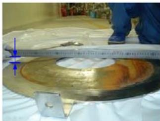
中心孔を頂上とした山形に最大17.5mmの変形
