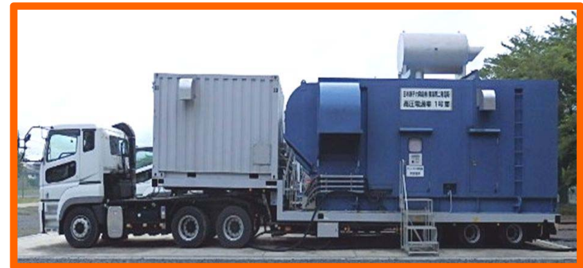
＜高圧電源装置＞
