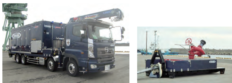
可搬型放水砲
