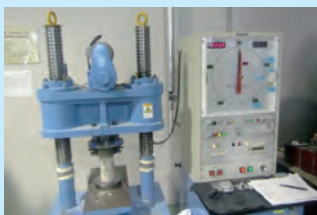
コンクリート強度試験
