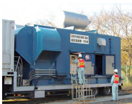
高圧電源装置を起動し、 発電所に電気を供給できることを確認
