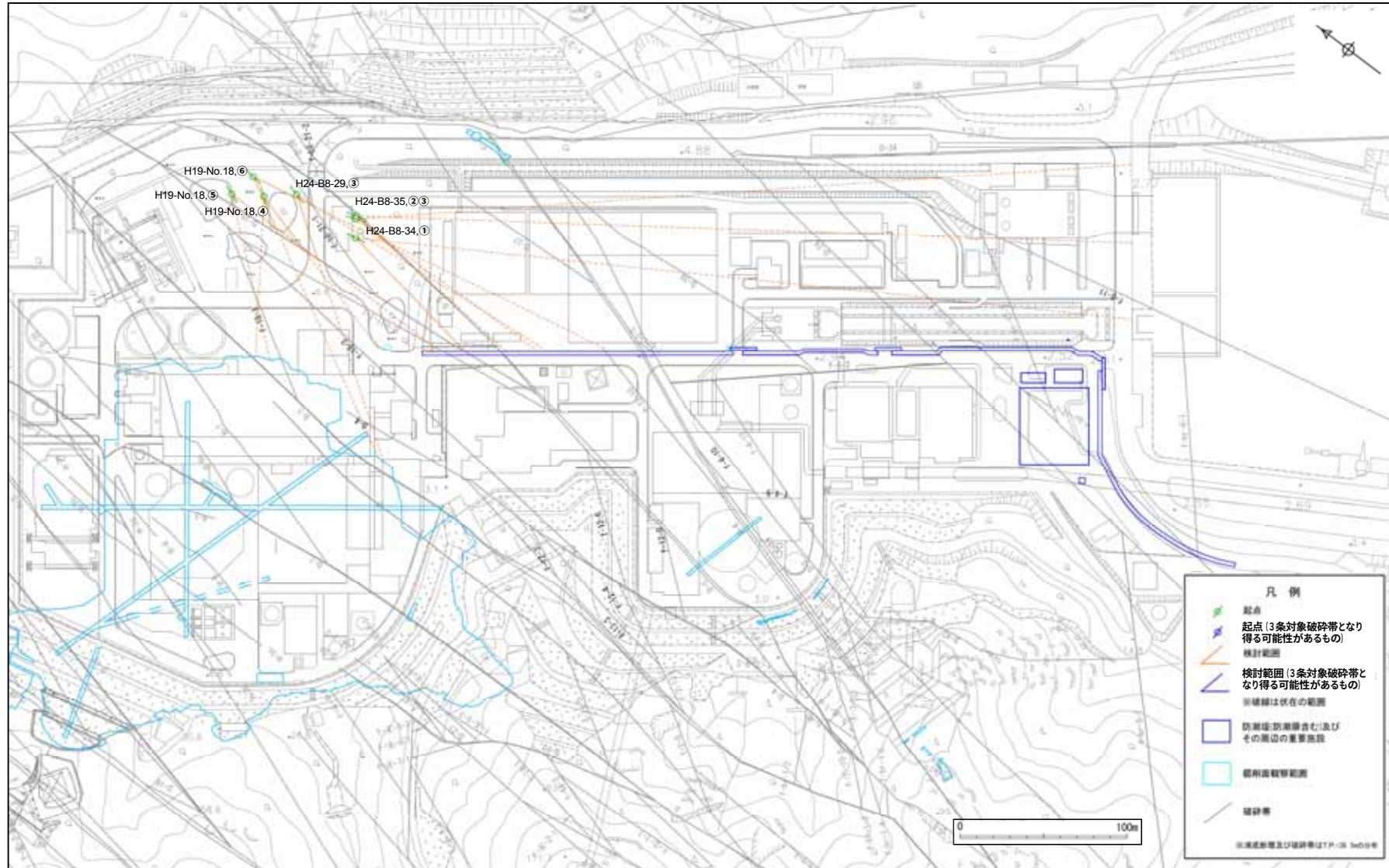
破碎帯の屈曲の可能性の範囲 (④防潮堤 (防潮扉含む) 及びその周辺の重要施設: 非モデル化破碎部 (その2))
