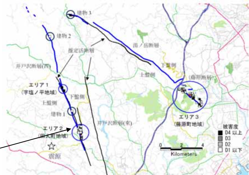
福島県浜通り地震による地表地震断層と断層の近傍での悉皆調査地点
