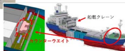
低レベル放射性廃棄物運搬船の 船載クレーンのカウンターウェイト
