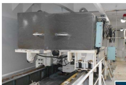
低レベル放射性廃棄物運搬船の 船載クレーンのカウンターウェイト
