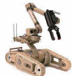
Warrior（障害物の除去用） （サイズは、幅約80cm×長さ約140cm×高さ約50cm）
