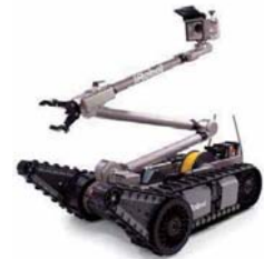
Packbot ® （災害現場の確認用） （サイズは、幅約50cm×長さ約90cm×高さ約20cm）
