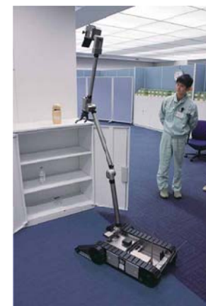
アーム伸縮操作訓練 アームを伸縮させ確実に目標物をつかむ訓練
