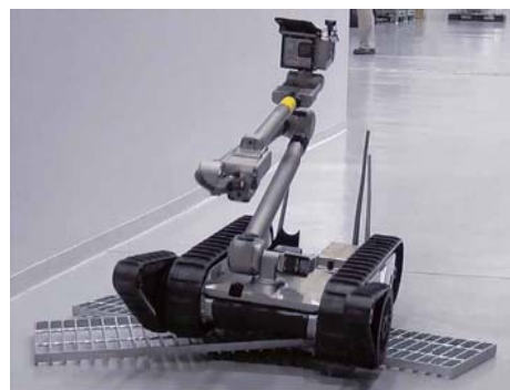
障害物上走行訓練 事故時の障害物を想定した訓練
