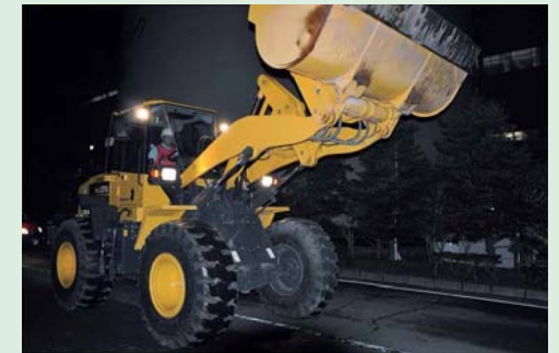
発電所内の道路にがれきなどが散乱してアクセスできなくなった場合を想定したホイールローダによる夜間の走行訓練
