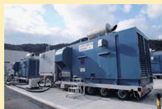
高压電源車 (電源容量: 1,825kVA×4台)
