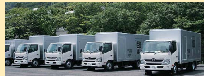
低压電源車 (電源容量: 500kVA×4台)
