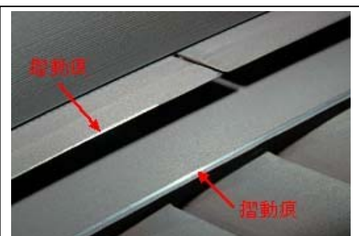
動翼・発電機側（第1段）
