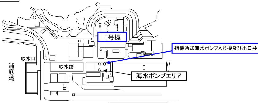
補機冷却海水系系統概略図
