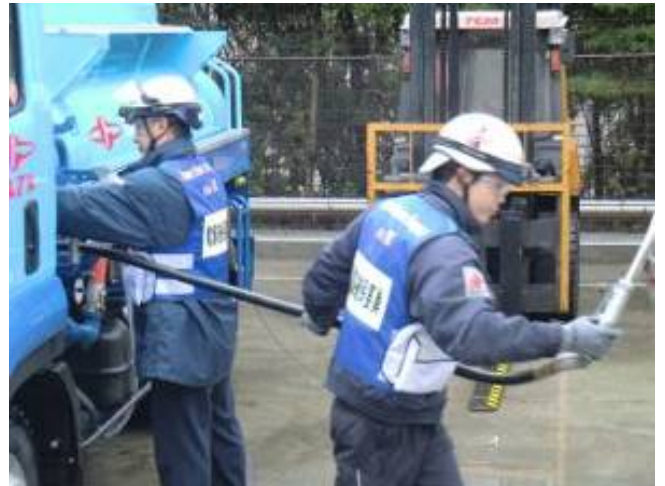
タンクローリーによる電源車への燃料補給
