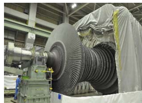
低圧タービンロータ解体前
