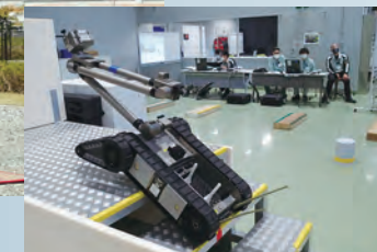
遠隔操作が可能な小型ロボット
