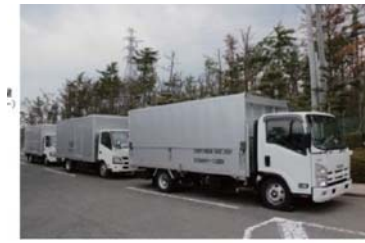
低圧電源車(500kVA, 4台)
