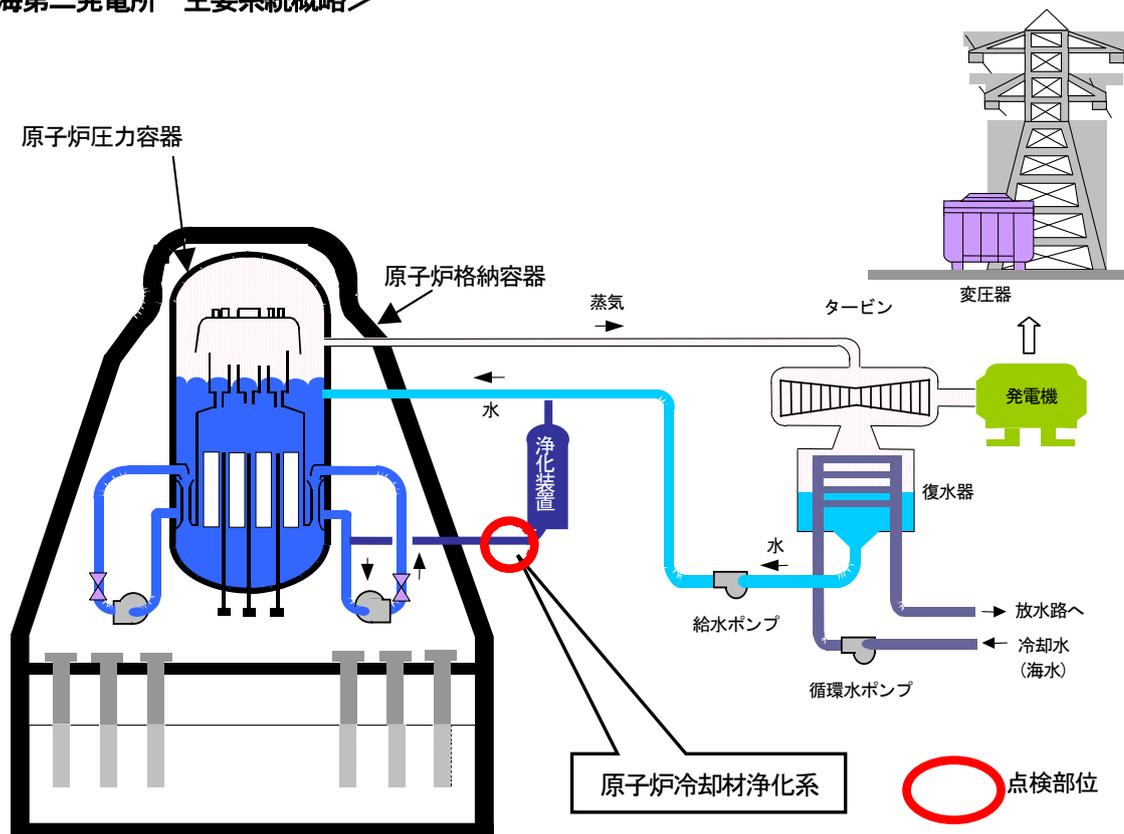
※1：原子炉冷却材浄化系
