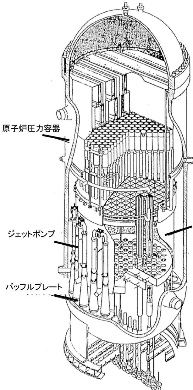
原子炉圧力容器 内部構造図
