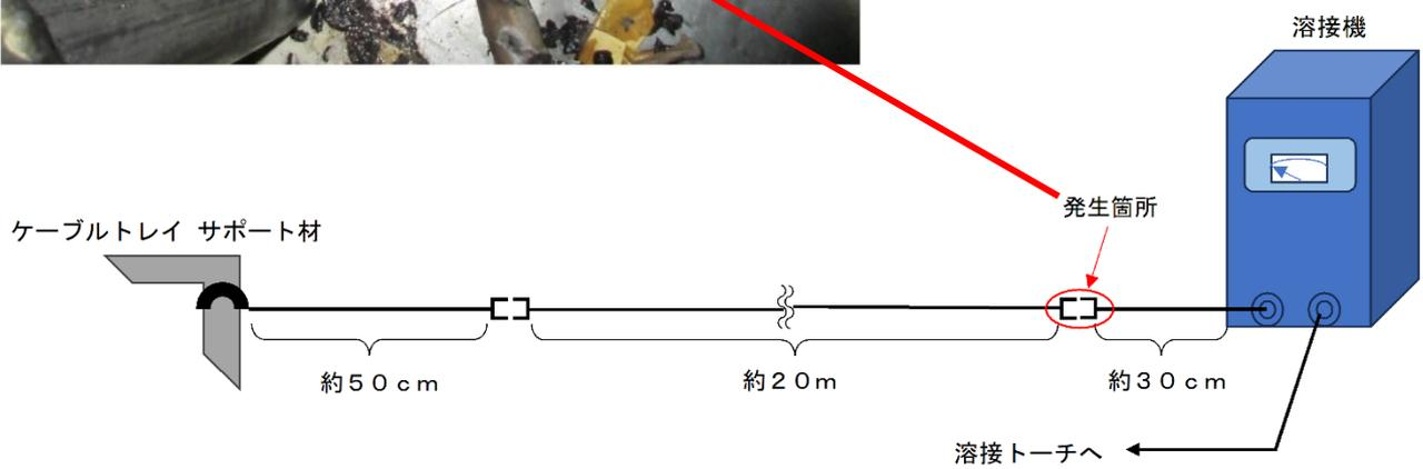
溶接用ケーブル（接地線）の全体概要図
