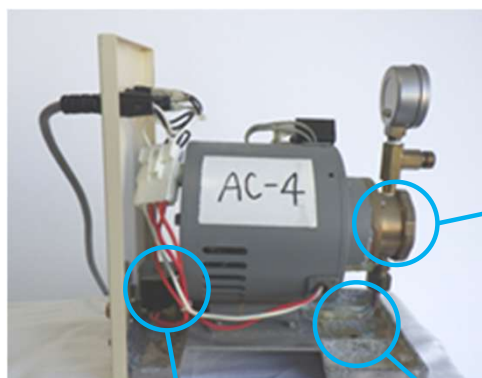
【当該加湿器電動機 (AC-4) 外観状況】
