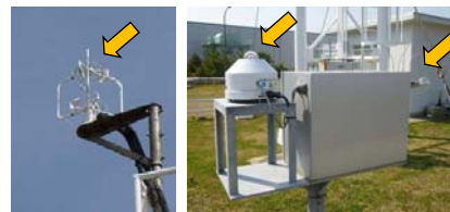
(風向風速計) (日射計(左)、放射収支計(右))
