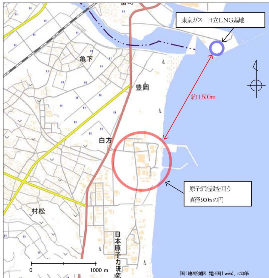
図 2.2.2.2-2 発電所に爆発影響が及ぶ可能性のある敷地外の高圧ガス貯蔵施設
