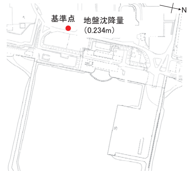
東海第二発電所内基準点測量位置
