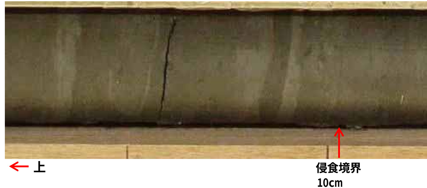
侵食境界Ⅱ／Ⅲ (②孔) (深度:164.41m)
