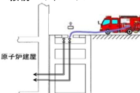
西側接続口イメージ(地下格納槽)
