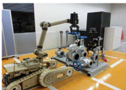
バルブの開閉操作
