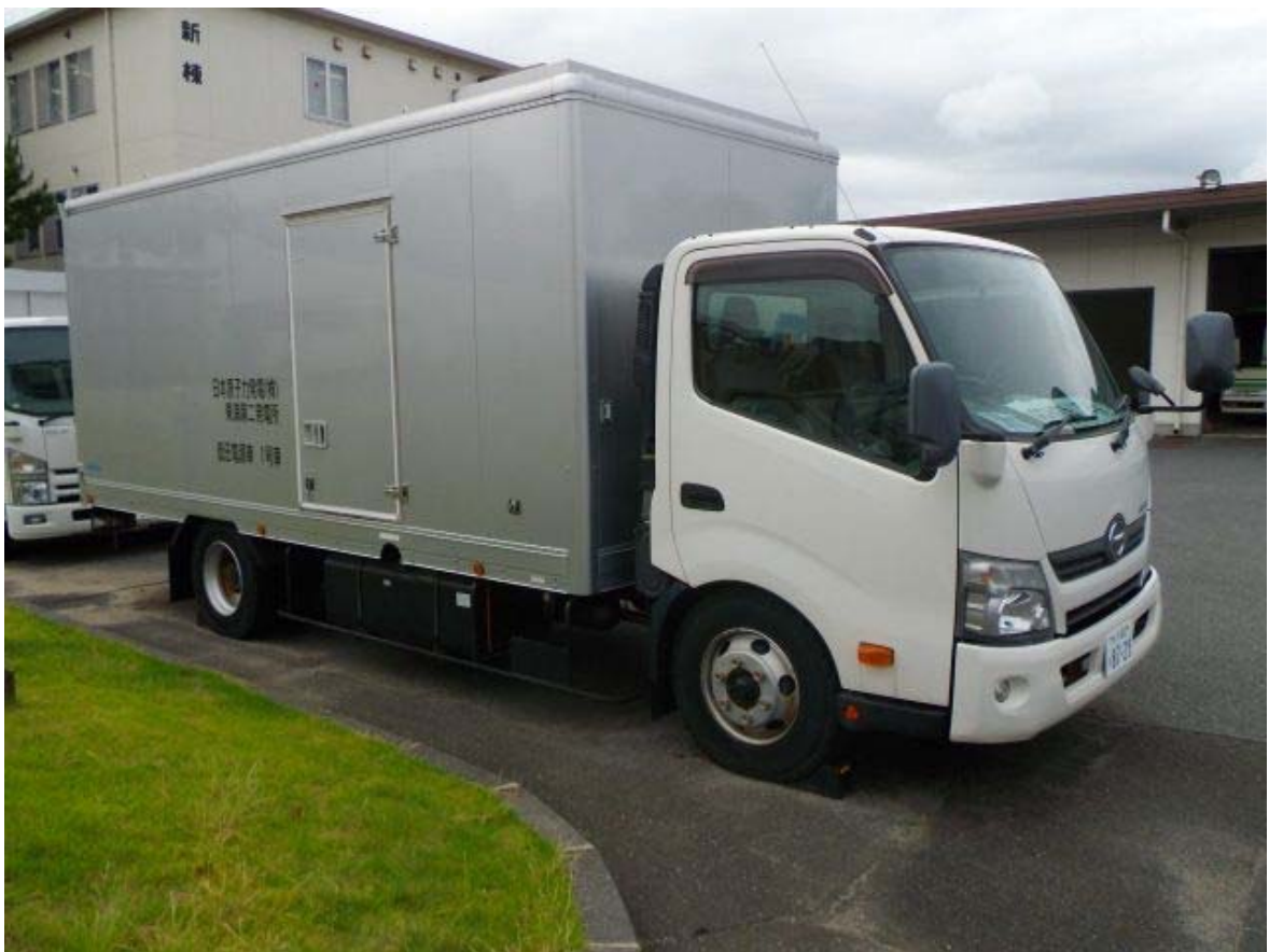
可搬型代替低圧電源車 外観
