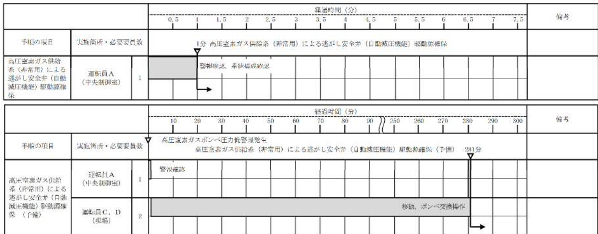
第 1.3－12 図 高圧窒素ガス供給系（非常用）による逃がし安全弁 （自動減圧機能）駆動源確保 タイムチャート
