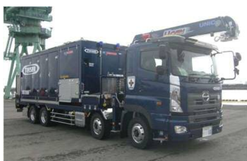
可搬型代替注水大型ポンプ
