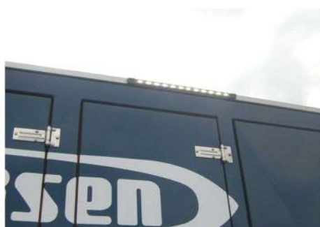
車両の作業用照明
