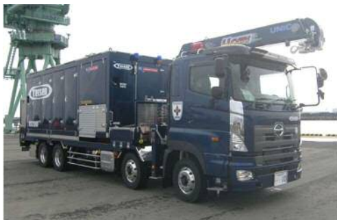
可搬型代替注水大型ポンプ
