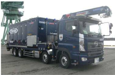
可搬型代替注水大型ポンプ
