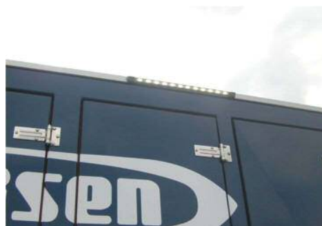
車両の作業用照明
