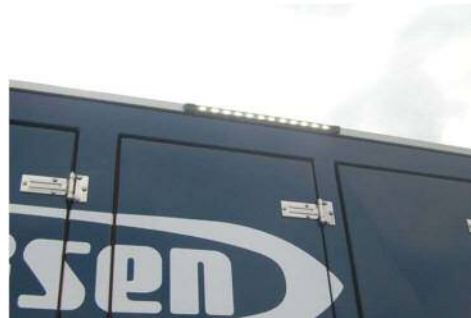
車両の作業用照明
