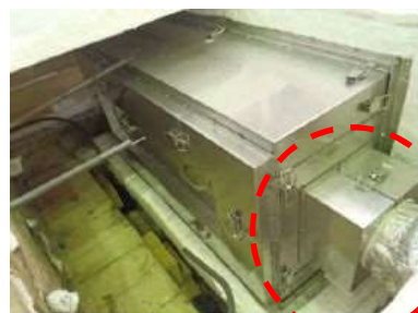
電動弁(火災耐久試験時の外観) 操作ハンドル部
