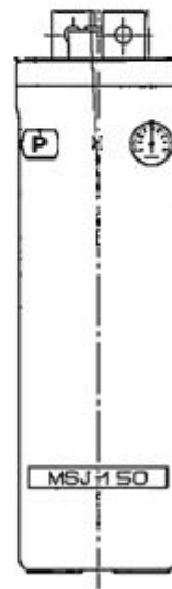
第 57-4-17 図 緊急用直流 125V 蓄電池構造図
