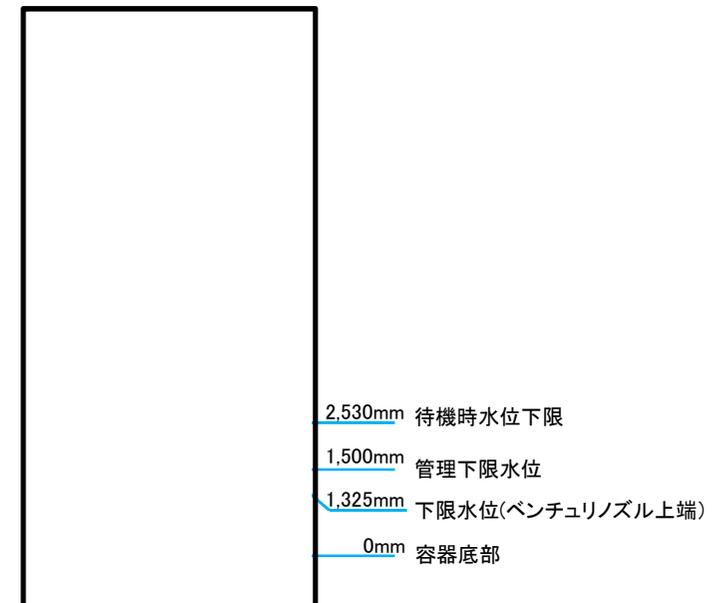
図5 フィルタ装置のスクラビング水位
