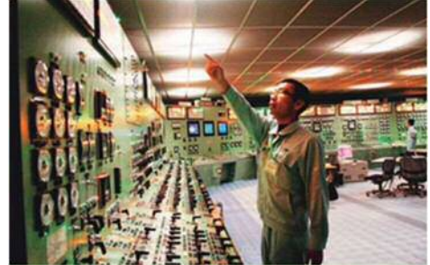
シミュレータを用いた運転操作訓練の状況 （写真は社外施設での実施状況、電源喪失時を想定）
