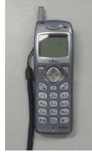
電力保安通信用 電話設備（携帯型）
