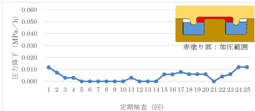
第 6 図 トップヘッドフランジ部リークテスト実績
