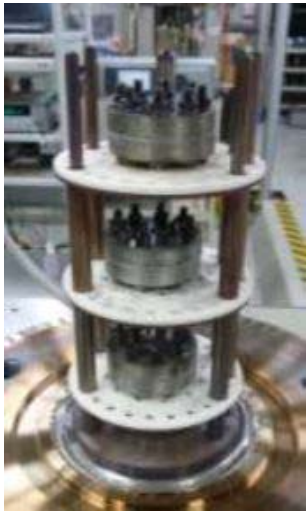
第4図 蒸気曝露 試験片設置状況
