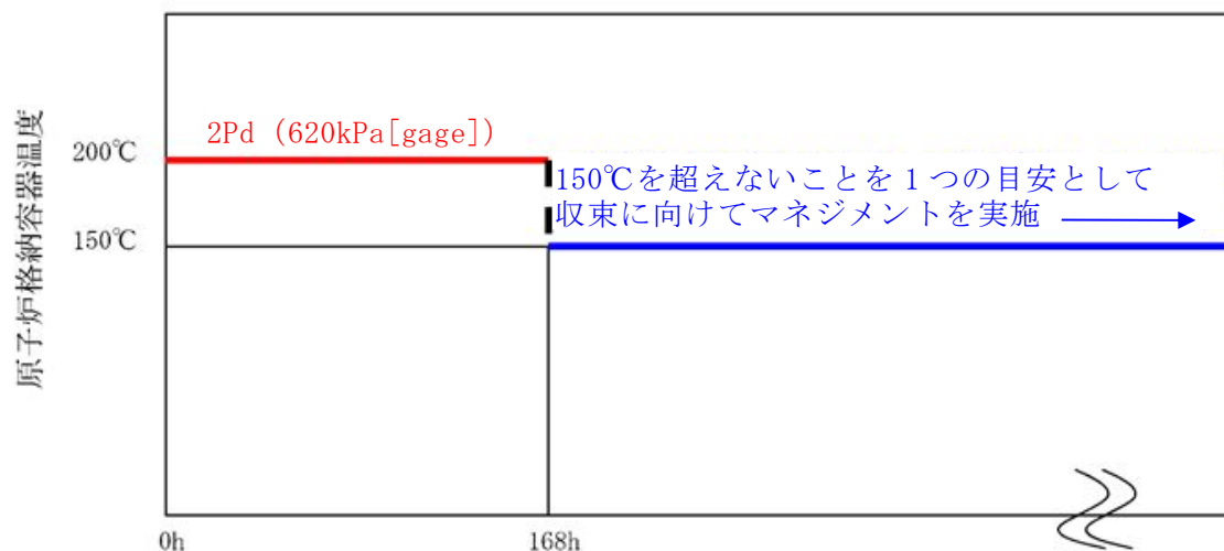
第 6 図 格納容器温度の 168 時間以降の考え方
