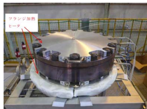
試験装置外観（フランジ密閉時）
