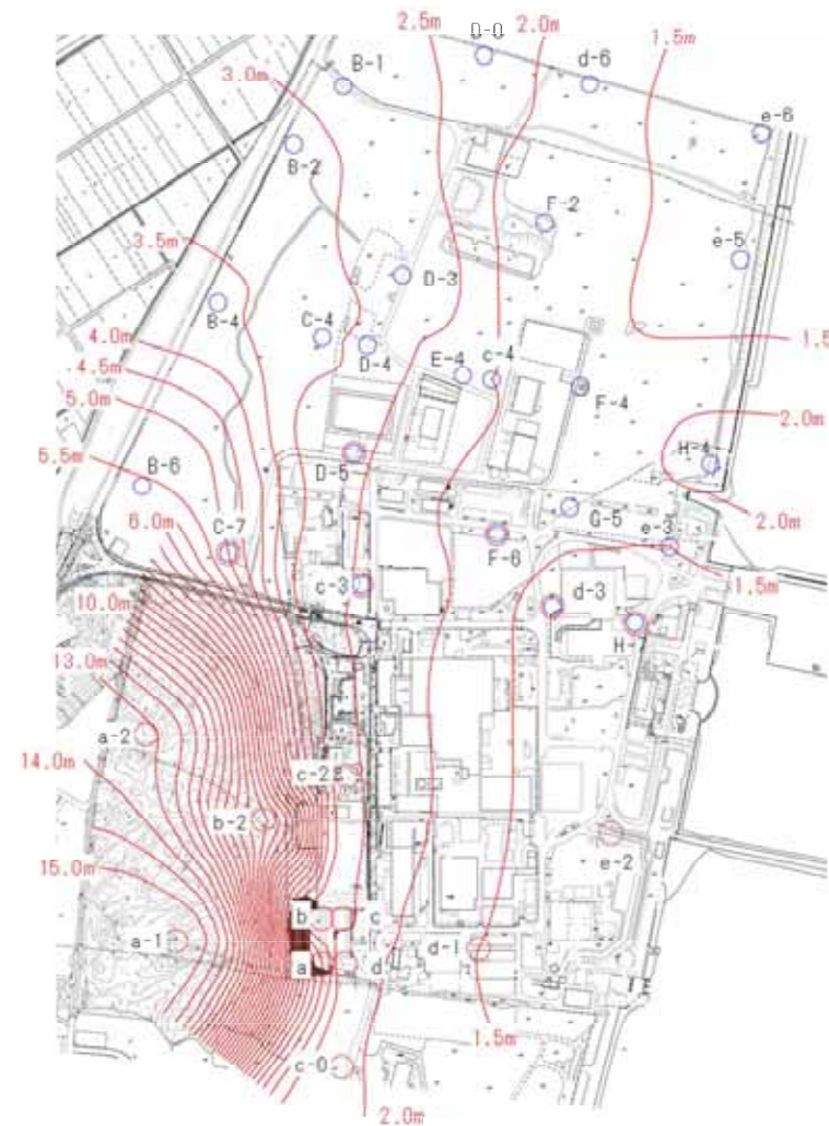
観測最高地下水位コンター図(T.P.+m)
