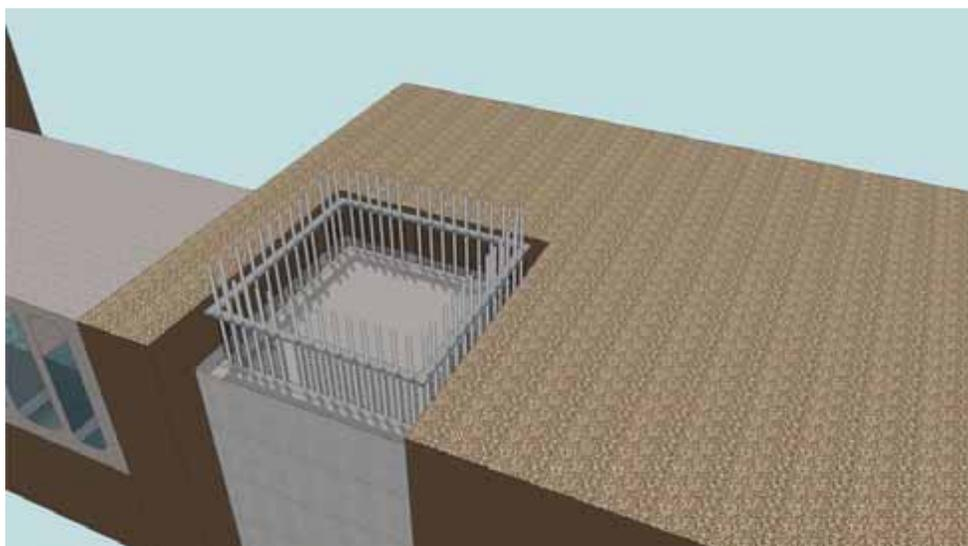
■ステップ2 支柱部ブロック設置・中詰め鉄筋コンクリート工
