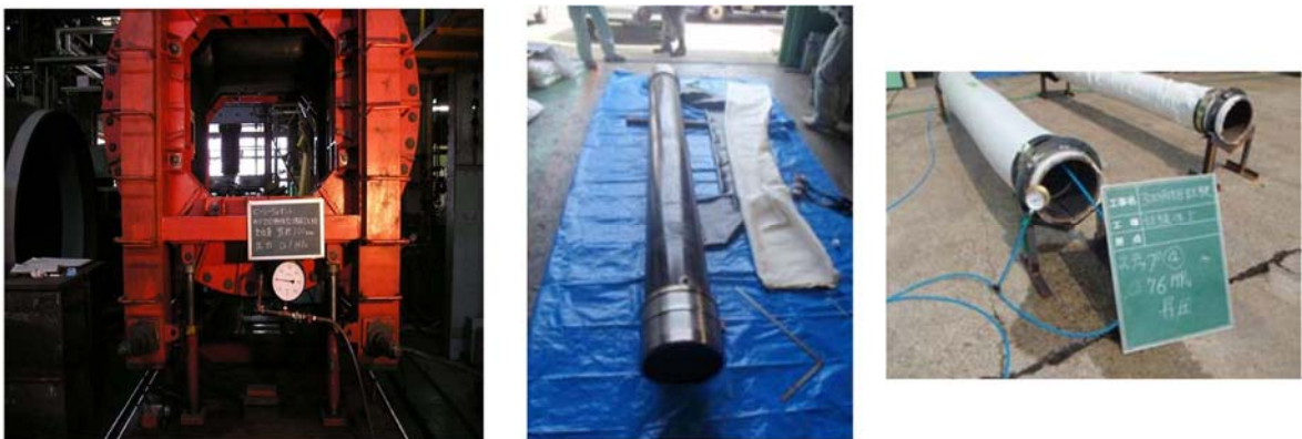
第 13 図 止水ゴム等の耐圧試験例
