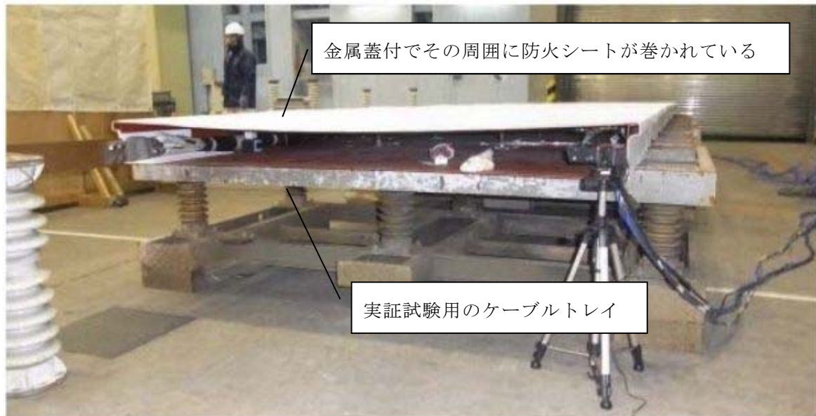
第 3 図 実証試験用のケーブルトレイ
