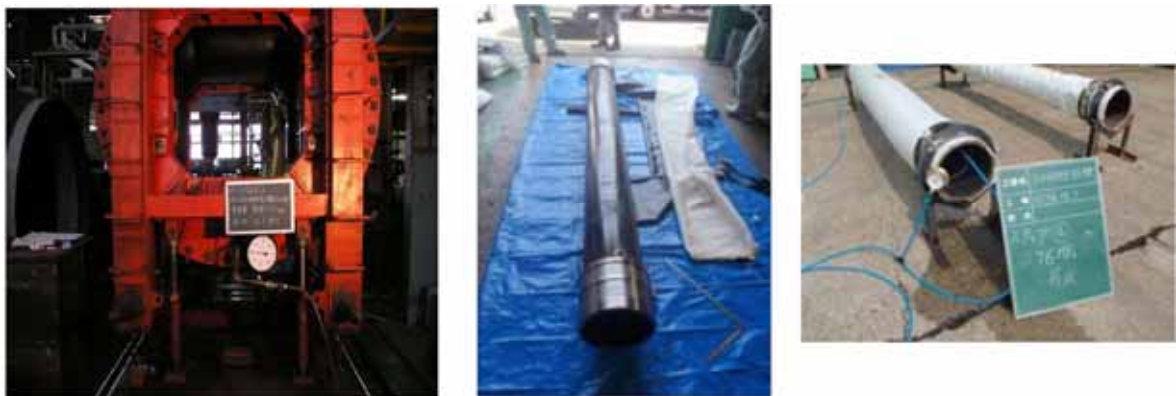
第 13 図 止水ゴム等の耐圧試験例
