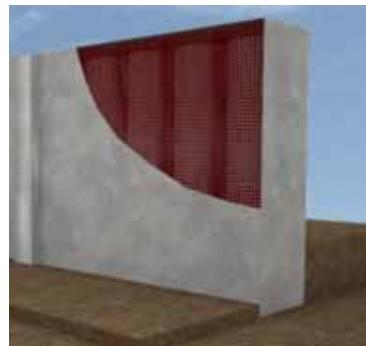
钢管鉄筋コンクリートの前面に一体化した鉄筋コンクリート梁壁のみで止水性を確保（実際には、鉄筋コンクリート梁壁と钢管鉄筋コンクリートは一体であり、両方とも止水性を有する（二重の止水効果））
