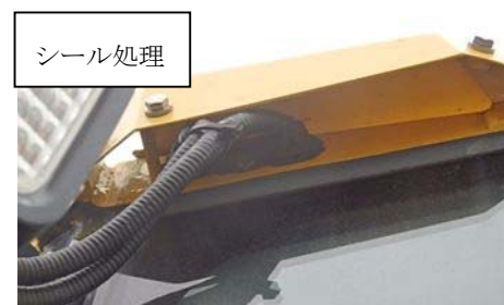
第1図 可搬型設備 小動物対策例 (2/2)
