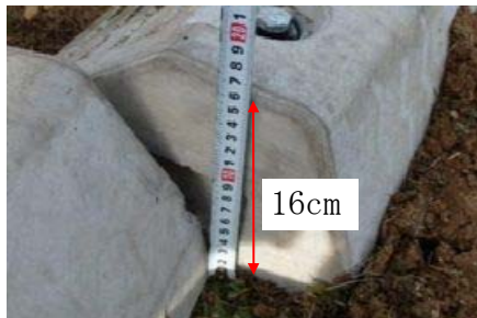
【段差復旧検証用段差】
