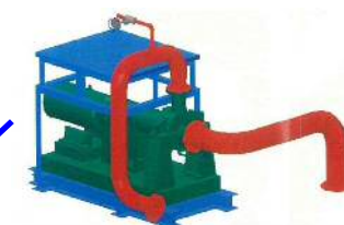
代替燃料プール冷却系ポンプ
