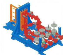
代替燃料プール冷却系熱交換器
