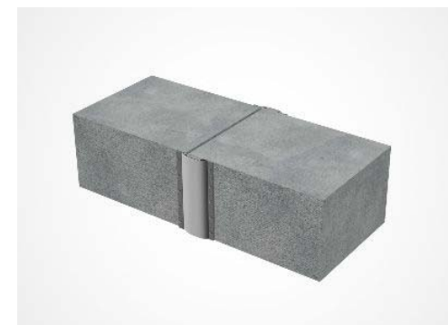
シートジョイント(土木シート: #800×2重, 遮水シート: 塩ビシート)
