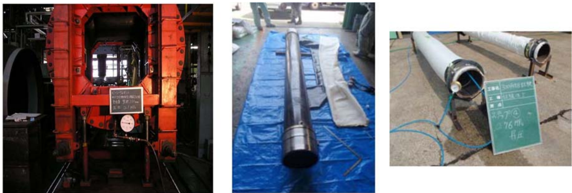
第 1-26 図 止水ゴム等の耐圧試験例
